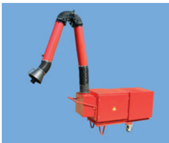
Рис. 3.2. Электростатический фильтр ЭФВА-МС-1-06, передвижной, с вентилятором и полноповоротным воздуховытяжным устройством ПВУ. Комплектуется гидрозатвором и по согласованию емкостью для сбора масел и эмульсий.
