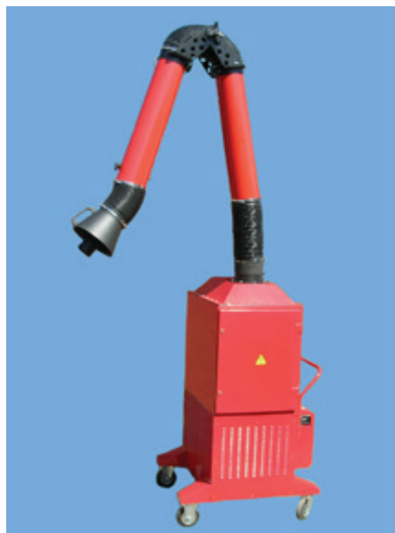
Рис. 3.3. Электростатический фильтр ЭФВА-МС-1,5-11, передвижной, с вентилятором и полноповоротным воздуховытяжным устройством ПВУ. Комплектуется гидрозатвором и по согласованию емкостью для сбора масел и эмульсий.
