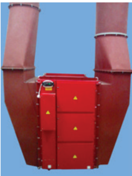
Рис. 3.11. Электростатический фильтр ЭФВА-МС-10-07М, стационарный, без с вентилятора, в комплекте с диффузором, конфузуром и воздуховодами. Комплектуется по согласованию гидрозатвором и емкостью для сбора масел и эмульсий.
