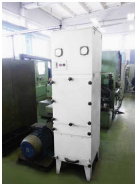
Рис. 1.3. Фильтры ФВА-М-750 для очистки воздуха от туманов масел и эмульсий, установленные на АВТОВАЗе.
