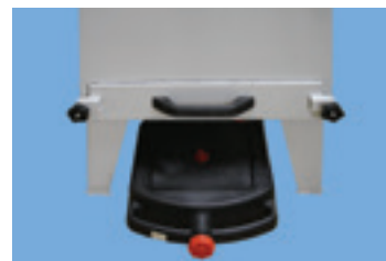
Контейнер для сбора пыли и стружки и емкость для сбора масел и эмульсий
