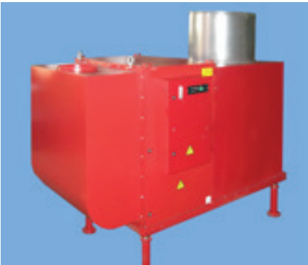
Рис. 3.9. Электростатический фильтр ЭФВА-МС-4-25, стационарный, с вентилятором и шумоглушителем. Комплектуется по согласованию гидрозатвором и емкостью для сбора масел и эмульсий.
