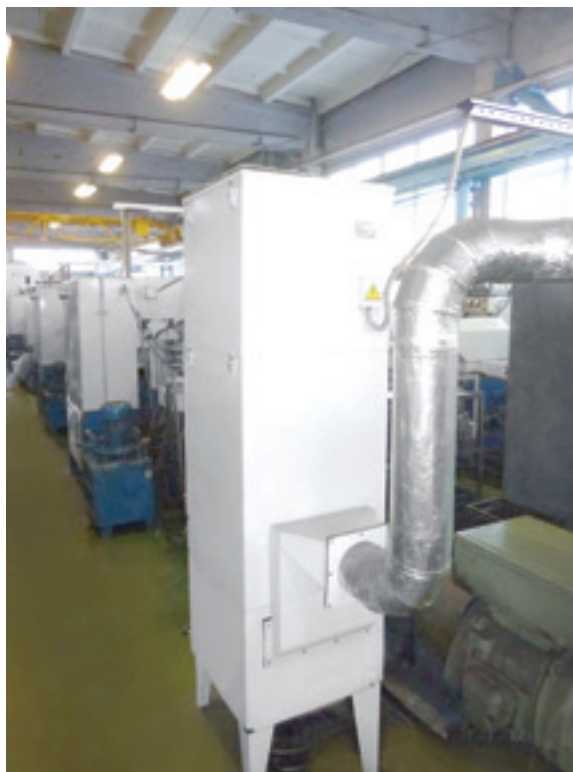
Рис. 1.3. Фильтры ФВА-М-750 для очистки воздуха от туманов масел и эмульсий, установленные на АВТОВАЗе.
