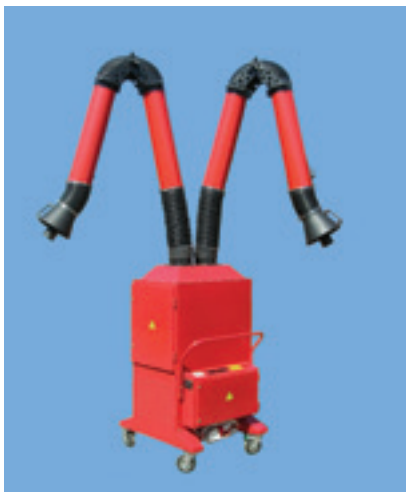
Рис. 3.4. Электростатический фильтр ЭФВА-МС-1,5-12, передвижной, с вентилятором и двумя полноповоротным воздуховытяжным устройством ПВУ. Комплектуется гидрозатвором и по согласованию емкостью для сбора масел и эмульсий.
