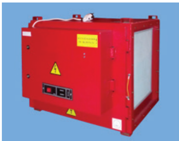
Рис. 3.1. Электростатический фильтр ЭФВА-МС-1-15, стационарный, без вентилятора. Комплектуется гидрозатвором и по согласованию емкостью для сбора масел и эмульсий.
